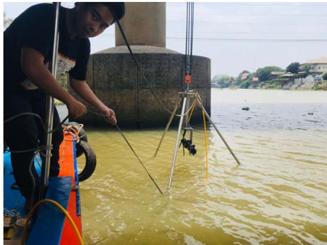
รูปที่ 4-3 การตั้ง Sonar Scan ที่ประกอบอุปกรณ์ Tripod สำหรับร่อนน้ำ
