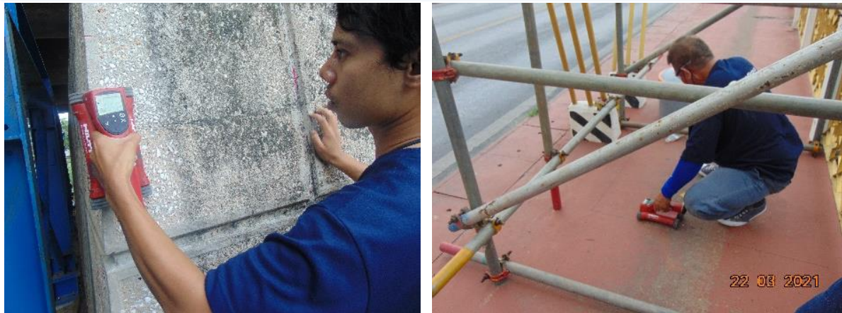
รูปที่ 5-3 ขั้นตอนลักษณะการสแกนโครงสร้างด้วยเครื่องมือ Ferro Scan
