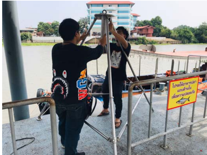
รูปที่ 4-2 การประกอบอุปกรณ์ Tripod สำหรับร่อนน้ำ
