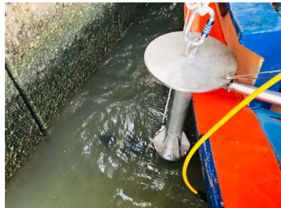
รูปที่ 4-1 การตั้ง Sonar Scan สำรวจตอม่อ
