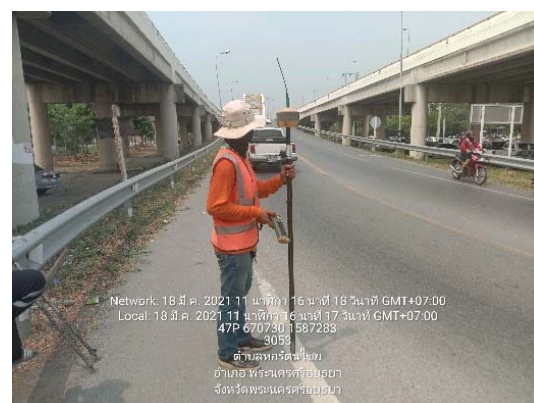
รูปที่ 2-9 การรังวัดพิกัดดาวเทียม GPS แบบ RTK (ต่อ)
